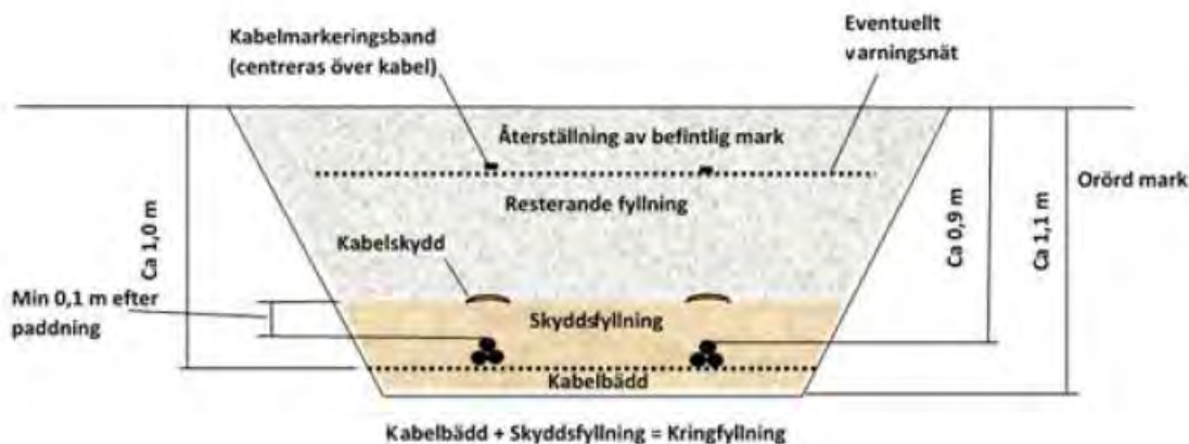
Figur 5. Principskiss på genomskäring av kabelgrav.
