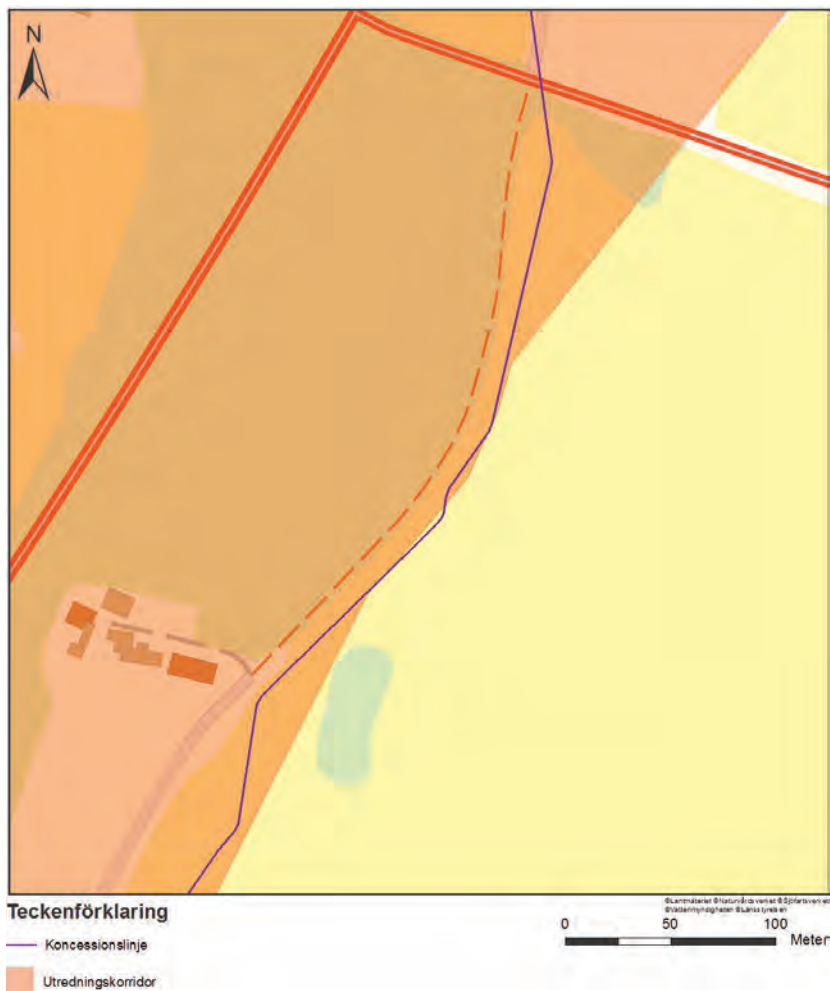
Figur 5 Vid Åsum, inom fastigheten [REDACTED] har koncessionslinjen placerats utanför utredningskorridoren på längsgående sträcka av ca 52 m. Avståndet mellan koncessionslinjen och utredningskorridoren är som mest 3 m.
