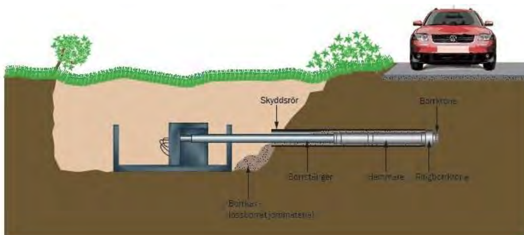
Figur 30. Principskiss över schaktfri metod hammarborring (skiss från Styrud AB).
