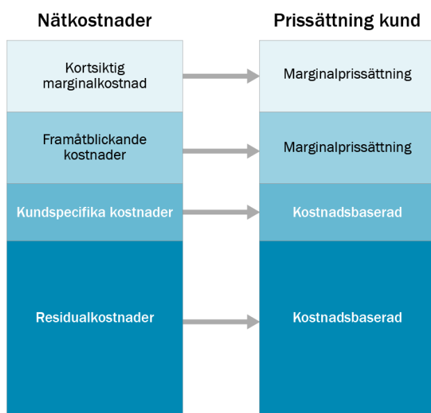
Figur 2 Koppling mellan nätrelaterade kostnader och hur de prissätts mot nätkunden
